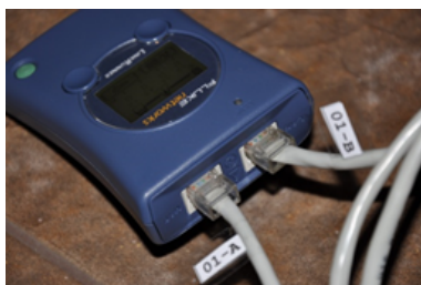
Rysunek 4.3: Tester okablowania LinkRunner z poprawnie podpiętym kablem.
